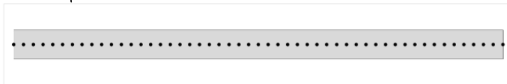
Εικόνα 1: Η χαρτοταινία στην οποία καταγράφεται η κίνηση του σώματος ( \Delta 1 ).
