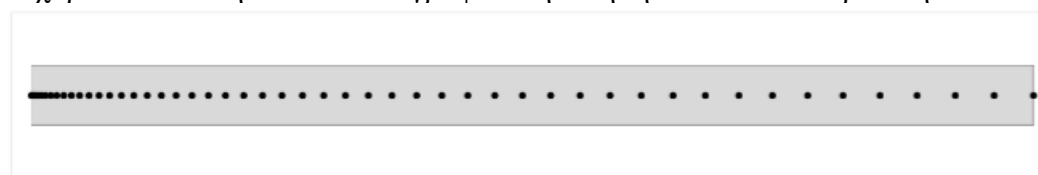
Εικόνα 2: Η χαρτοταινία στην οποία καταγράφεται η κίνηση του σώματος ( \Delta 2 ).
