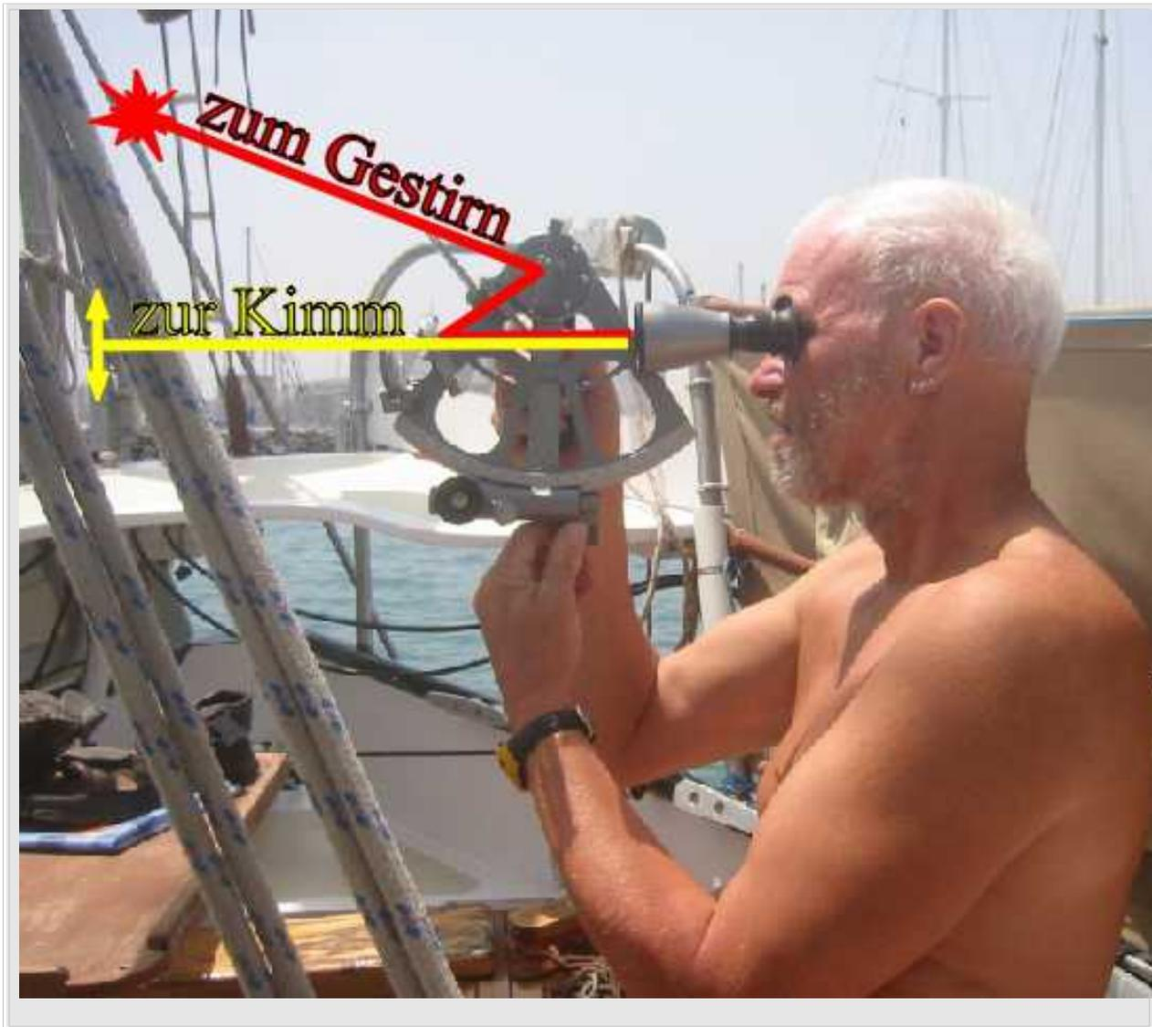
Bei der astronomischen Navigation wird das Bild eines Gestirns durch Verstellung der Alhidade bis zur Berührung gebracht; das Bild des Objektes gelangt über die Spiegel und das des Horizontes in direkter Sicht ins Fernrohr.
