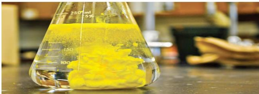
Figura 1.53 La formación del yoduro de plomo es muy evidente, ya que además de formarse un precipitado, hay un marcado cambio de color.
