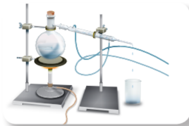
Figura 1.30 Las sustancias de la mezcla pasan al refrigerante en forma gaseosa, ahí se condensan y caen, como líquidos, en otro recipiente.
