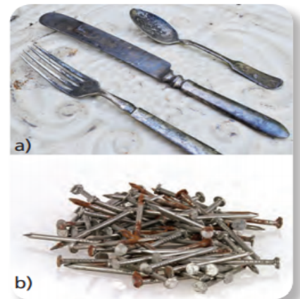
Figura 3.2 a) Los objetos de plata reaccionan con el azufre del aire cubriéndose con una capa negra de sulfuro de plata; b) los de hierro reaccionan con el oxígeno generando el óxido de hierro que le da su aspecto rojizo.
