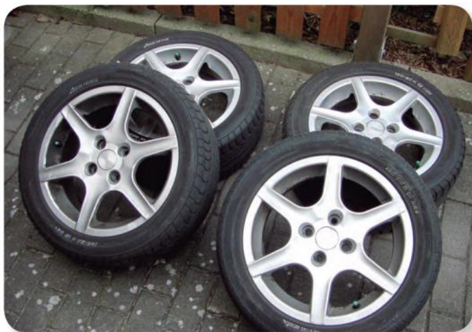
Figura 3.26 Es habitual que en los medios de transporte se use aluminio, debido a su bajo costo, alta reciclabilidad y baja corrosividad.
