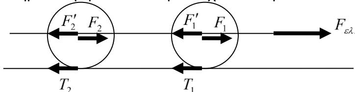
Στη σανίδα ασκείται η  $F_{\text{el.}} = -kx$ . Η σανίδα ασκεί δυνάμεις μέτρων  $F_1$  και  $F_2$  στα κέντρα μάζας των τροχών, και αντίστοιχα οι τροχοί ασκούν αντιδράσεις με μέτρα  $F'_1 = F_1$  και  $F'_2 = F_2$ . Για τις κινήσεις των σωμάτων ισχύει:
