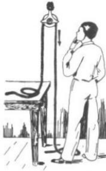
Explicación evidente de cómo funciona el sifón.
