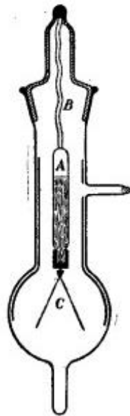
Figura 100. Reloj de radio con "cuerda casi perpetua" para 1.600 años.
