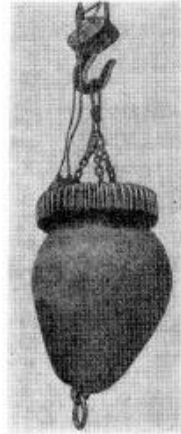
Figura 95. El electroimán de una grúa transportando un bloque de hierro de 6,5 t.
