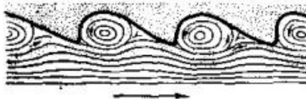
Fig. 82. Formación de las ondas en la arena de la playa por la acción de los remolinos del agua.
