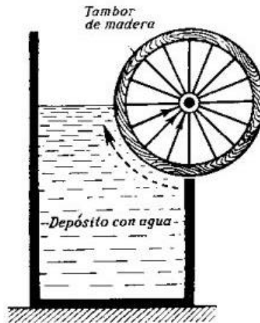
Fig. 57. Otro proyecto de móvil "perpetuo" hidráulico.
