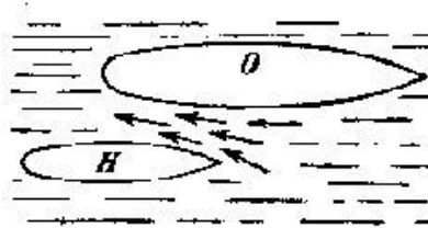
Fig. 71. Corriente de agua entre dos buques que navegan juntos.
