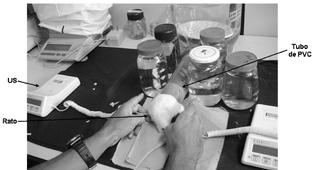
Figura 1. Observa-se o rato mantido no tubo de PVC e cada transdutor de dois equipamentos de USbp em contato com cada uma das patas posteriores do animal.
