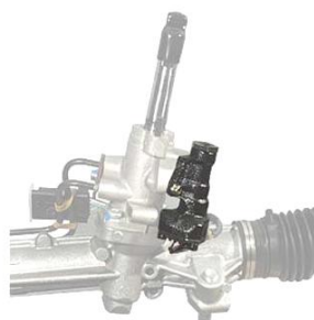
Válvula distribuidora con motor paso a paso.
