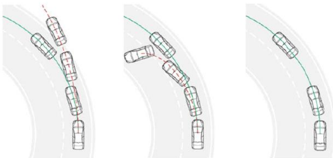
Trayectoria subvirante. Trayectoria sobrevirante. Trayectoria corregida.
