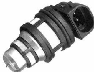
La válvula de inyección es del tipo electromagnético y los impulsos de inyección se producen con la misma frecuencia que los impulsos del circuito de encendido. El combustible se pulveriza encima de la mariposa en forma de hoz. Para poder dosificar cantidades mínimas de combustible, tanto el inducido como el muelle, presentan masas reducidas que permiten tiempos de apertura del inyector inferiores a una milésima de segundo. En caso de avería el motor se para por falta de combustible.
