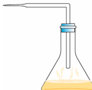
Matraz con tubo de desprendimiento
