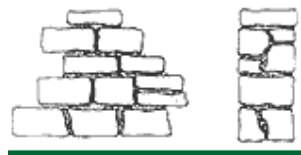
Pedras com aparelho parcial, dispostas em camadas.
