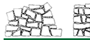
Pedras angulosas dispostas irregularmente com uma face aparelhada
