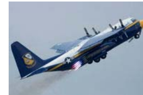
AVIÓN HÉRCULES : Vehículo de transporte aéreo, para carga, eminentemente militar, con el máximo VOLUMEN disponible, hasta la fecha, para cuyo despegue, en pista corta, requiere de Cohetes propulsores complementarios; Siglo XX, EUA.
