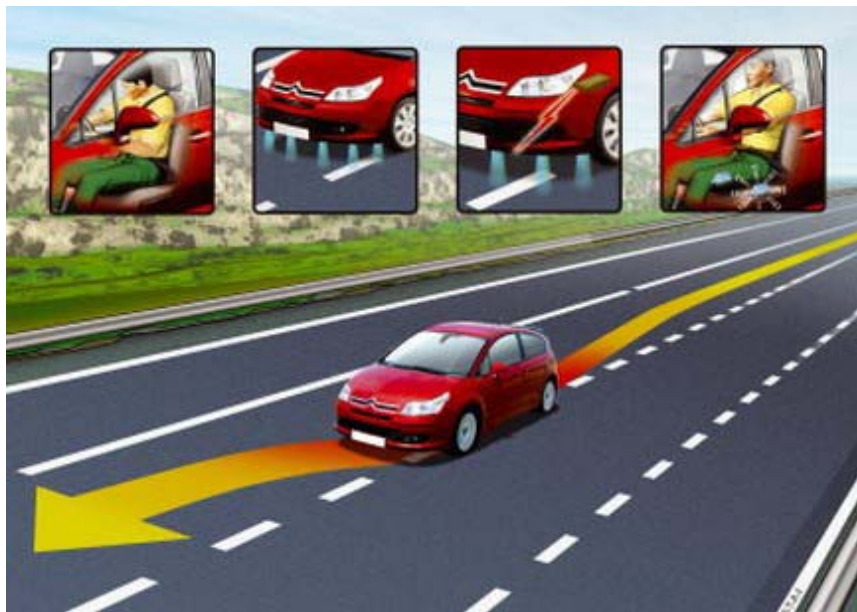
Sistema de alerta de cambio de carril de CITROEN que utiliza sensores infrarrojos para la detección de la línea.
