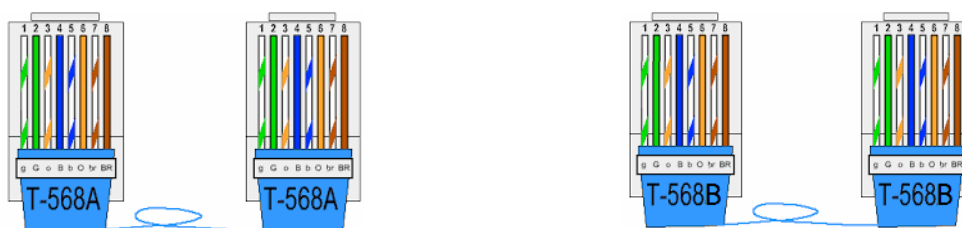
ก) เข้าหัวสายมาตรฐาน EIA/TIA 568A ทั้งคู่ ข) เข้าหัวสายมาตรฐาน EIA/TIA 568B ทั้งคู่
