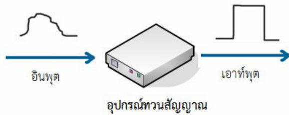
รูปที่ 2.19 ลักษณะการทวนสัญญาณของรีพีตเตอร์
