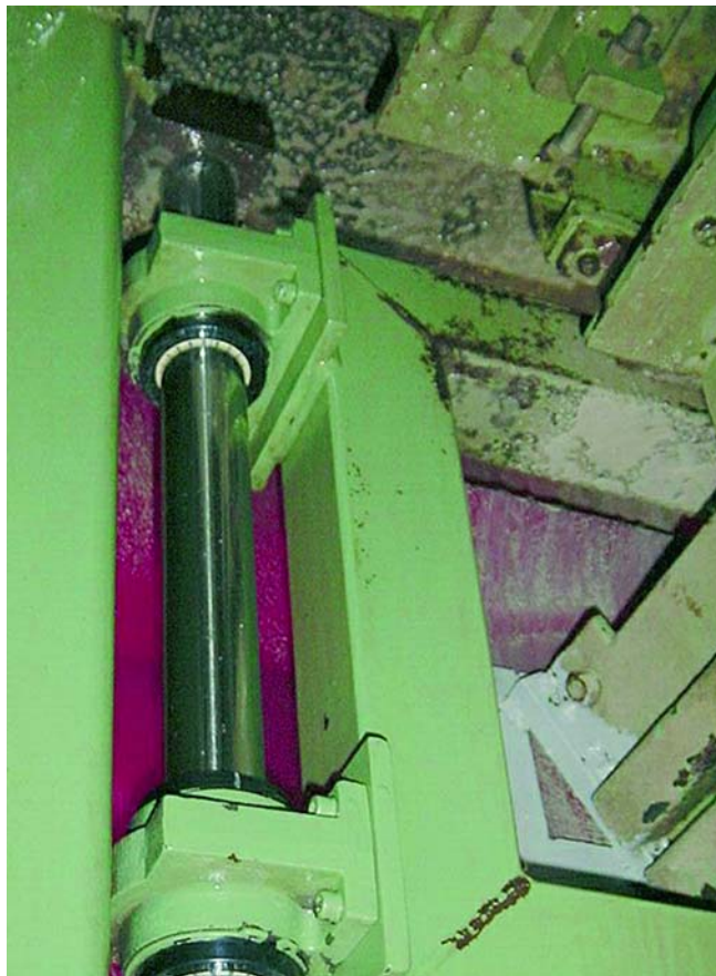
Imagen PM0805-02: Haas Maschinenbau, Oberbrück Fresadora de tubos de hormigón en el barro: Como aquí no funcionan los rodamientos, la empresa Haas Maschinenbau (Oberbrück) los sustituyó por el sistema lineal deslizante DryLin de igus. Desde hace más de tres años, la máquina funciona sin ningún fallo.
