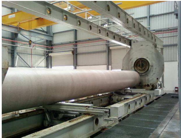
Conduite en PRV dans les usines d'Amitech à Casablanca
