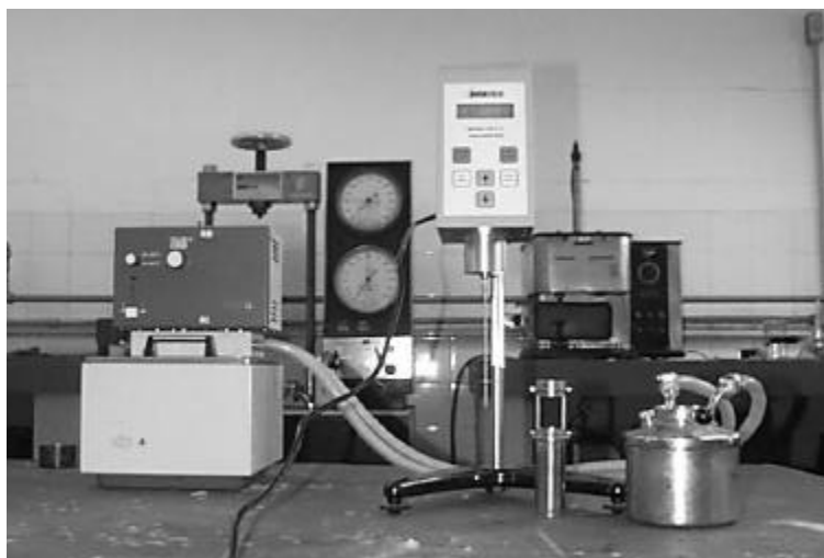
FIGURA 5.9 - Viscosímetro Brookfield utilizado para determinar a viscosidade aparente de ligantes asfálticos
