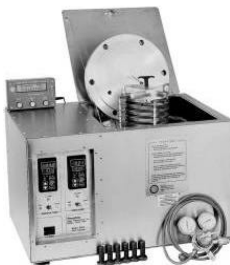
FIGURA 5.18 - Vaso de pressão (PAV) utilizado para envelhecimento acelerado de ligantes asfálticos
