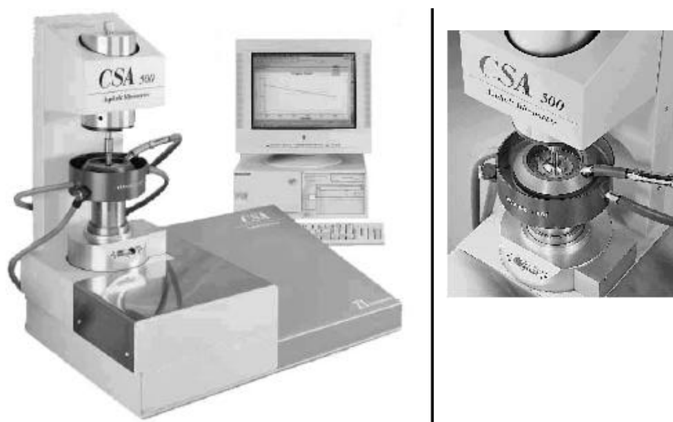
FIGURA 5.13 - Reômetro de cisalhamento dinâmico (Fonte: TA INSTRUMENTS, 1999)
