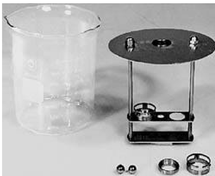
FIGURA 5.4 - Equipamento utilizado na determinação do ponto de amolecimento de ligantes asfálticos - Método Anel e Bola
