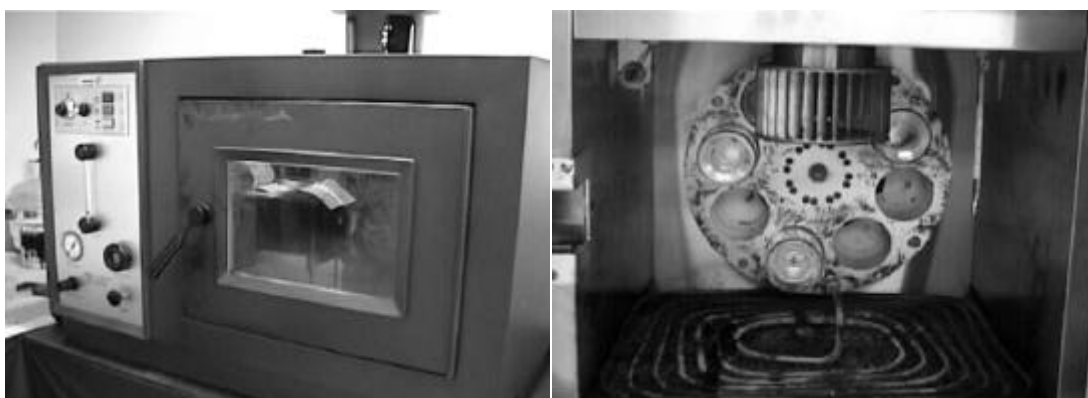
FIGURA 5.16 - Estufa de Filme Fino Rotativo (Ensaio RTFOT)
