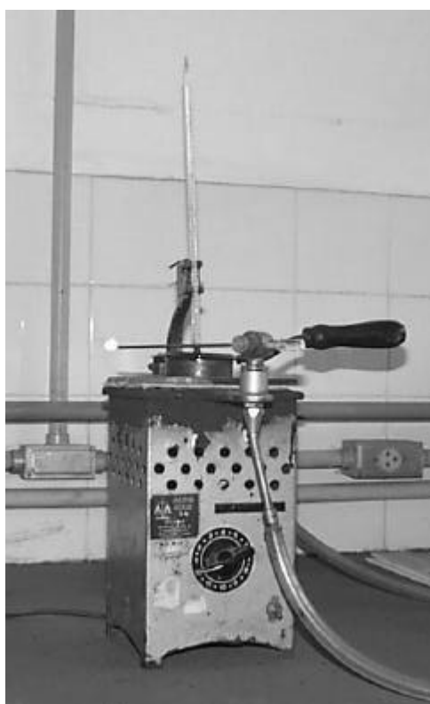
FIGURA 5.5 - Equipamento utilizado na determinação do ponto de fulgor de ligantes asfálticos
