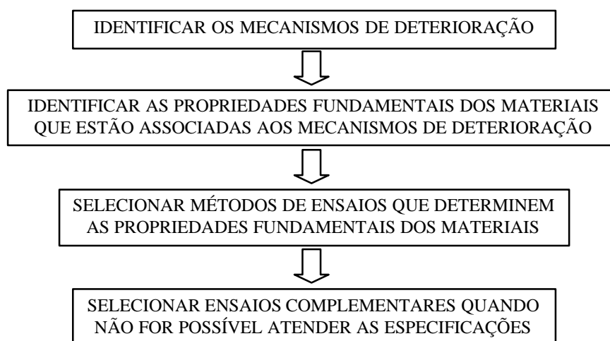
FIGURA 5.8 - Fluxograma da estratégia utilizada no desenvolvimento da especificação de ligante asfáltico Superpave (adaptado de ANDERSON et al. , 1991)
