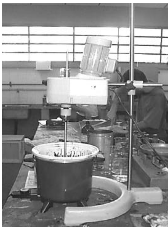
FIGURA 4.8 - Agitador mecânico e panela elétrica utilizados na preparação dos ligantes asfalto-borracha no Laboratório de Estradas do Departamento de Transportes da EESC/USP
