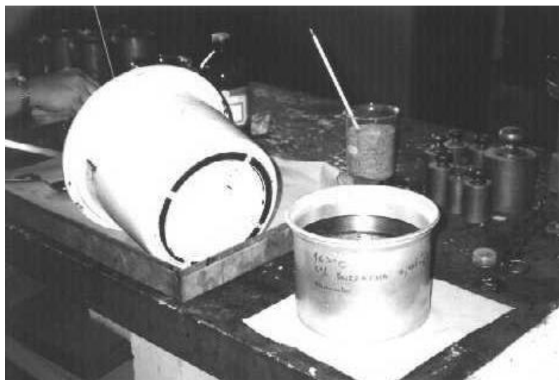
FIGURA 4.9 – Recipiente utilizado para armazenar o ligante asfalto-borracha
