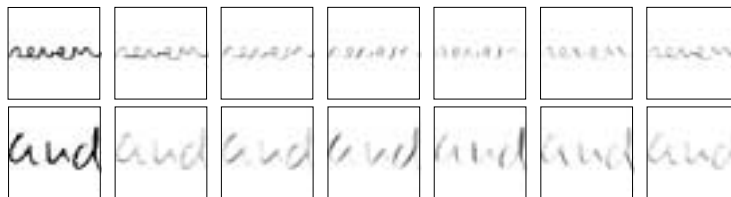
FIG. 4.11 – Extraction de caractéristiques directionnelles par l'utilisation de secteurs symétriques. A gauche, des images de test. A droite, les cartes de caractéristiques correspondantes.
