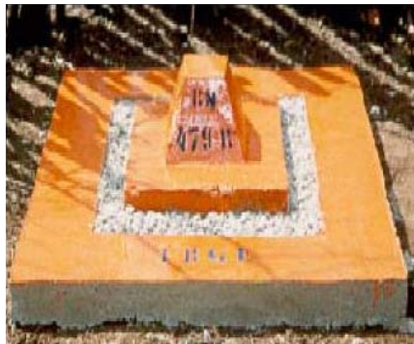
Figura 4 - Marco padrão IBGE com identificação em baixo relevo.
