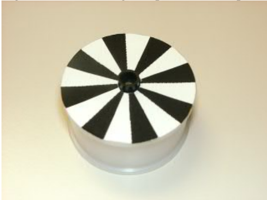
Figura 4: Código en la rueda para encoders
