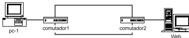
**FIGURA A6-1:** Topologia com laço entre comutadores.
