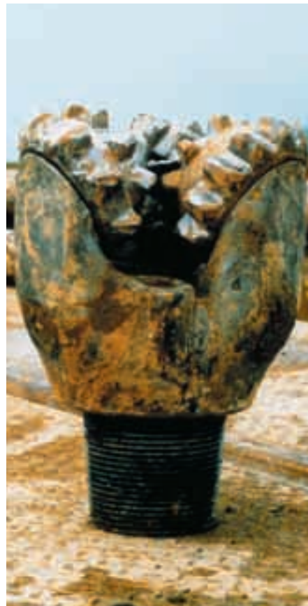
Selon la roche, la tête de forage doit être changée tous les 150 à 200 m.
