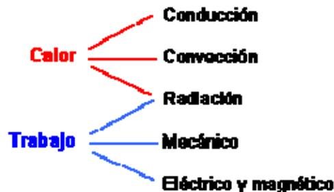
FIGURA 1. Diferentes formas de transmisión de la energía.
