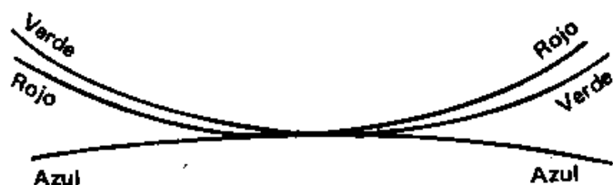
Fig. 6-18 Corrección de la curvatura de la línea horizontal central.
