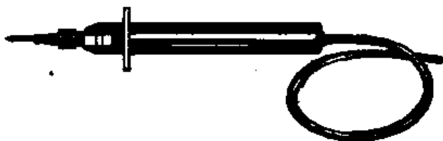
Fig. 10-2 Punta de alta tensión muy indicada para medir la tensión del ánodo final del TRC.
