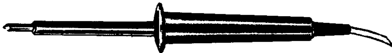
Fig. 10-1 Soldador del tipo adecuado para trabajos de reparación con televisores de estado sólido.
