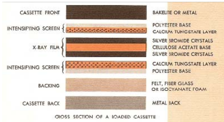
Gambar Potongan melintang kaset beserta intensifying screen dan film sinar-x
