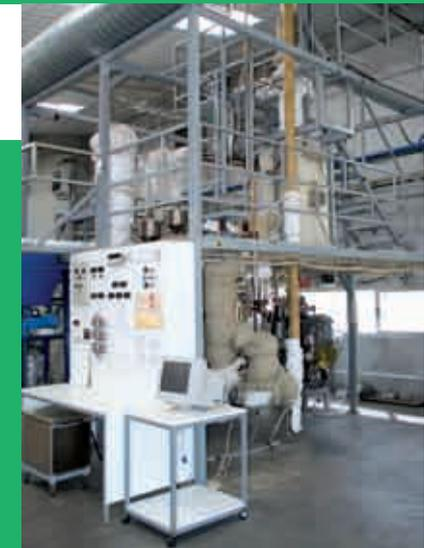
Planta piloto de combustión con TO (10 kW)
