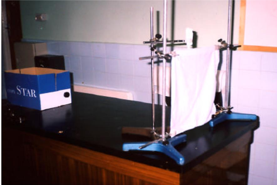
**2ª fotografía:** disposición del anemómetro (fabricado por nosotros) para la medida de la velocidad del aire de llegada. Está colocado con las medias esferas en la misma posición del centro del pañuelo. Encima de la mesa se encuentra el secador fuera de su caja que le da estabilidad.
