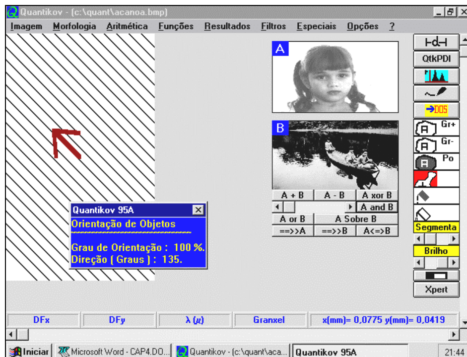
Figura 4.12 - Tela do Quantikov, apresentada no ambiente Windows 95™, mostrando um exemplo de determinação da orientação em linhas diagonais com um ângulo de 135 graus.
