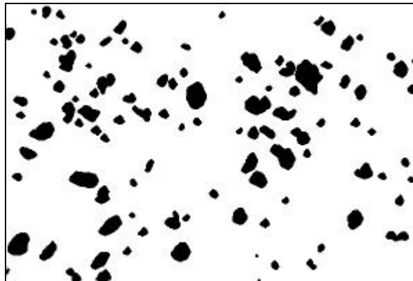
Figura 5.18c - Após segmentação e utilização do operador closing.
