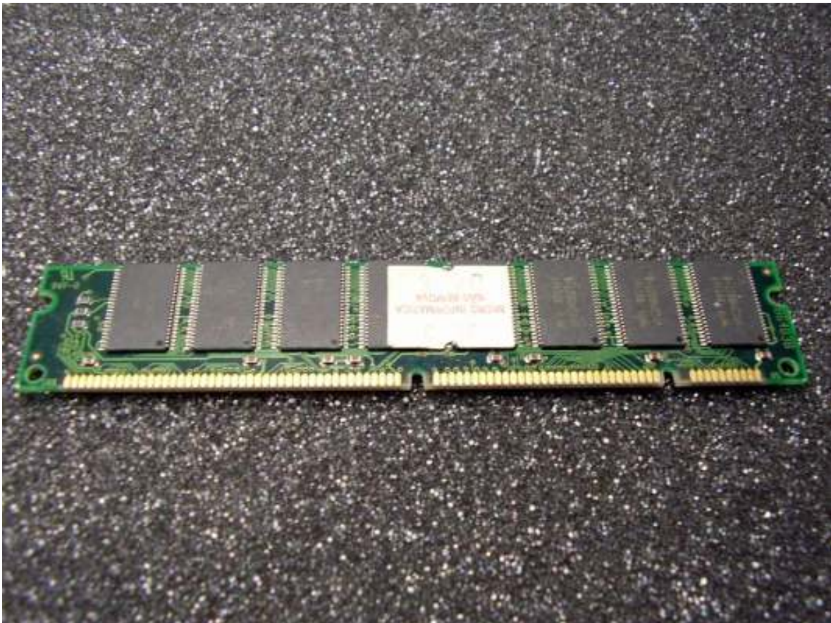
Ilustração 5 - Módulo de Memória DIMM
