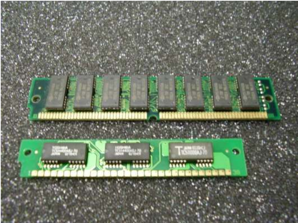
Ilustração 4 - Módulos SIMM de 30 e 72 vias
