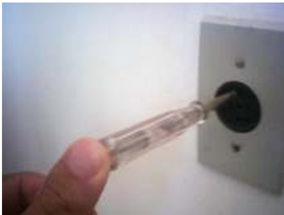
Ilustração 3 - Uso da chave teste
