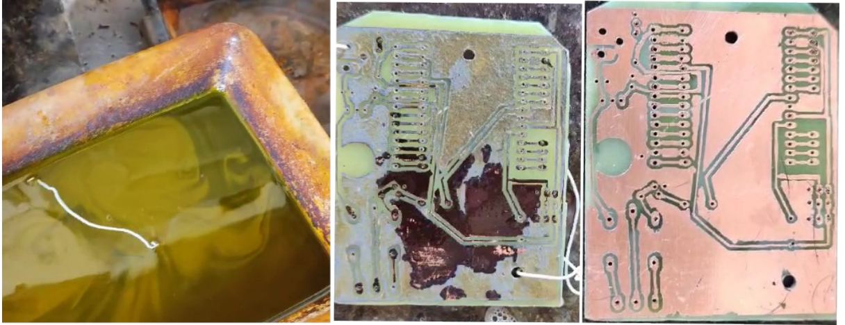
Figura 9: Corrosão da placa
