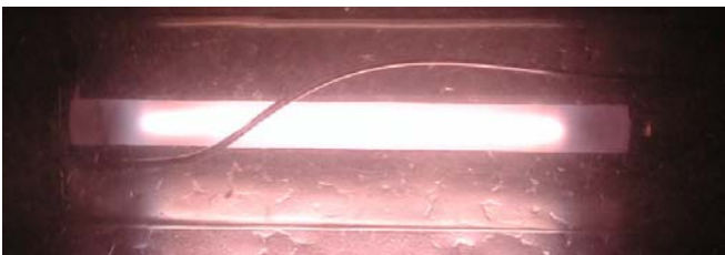
Fig. 13. Foto da Ressonância Em Lâmpada OSRAM - 40,1kHz.
