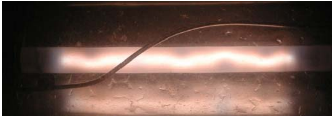
Fig. 11. Foto da Ressonância Em Lâmpada OSRAM - 20,6kHz.
