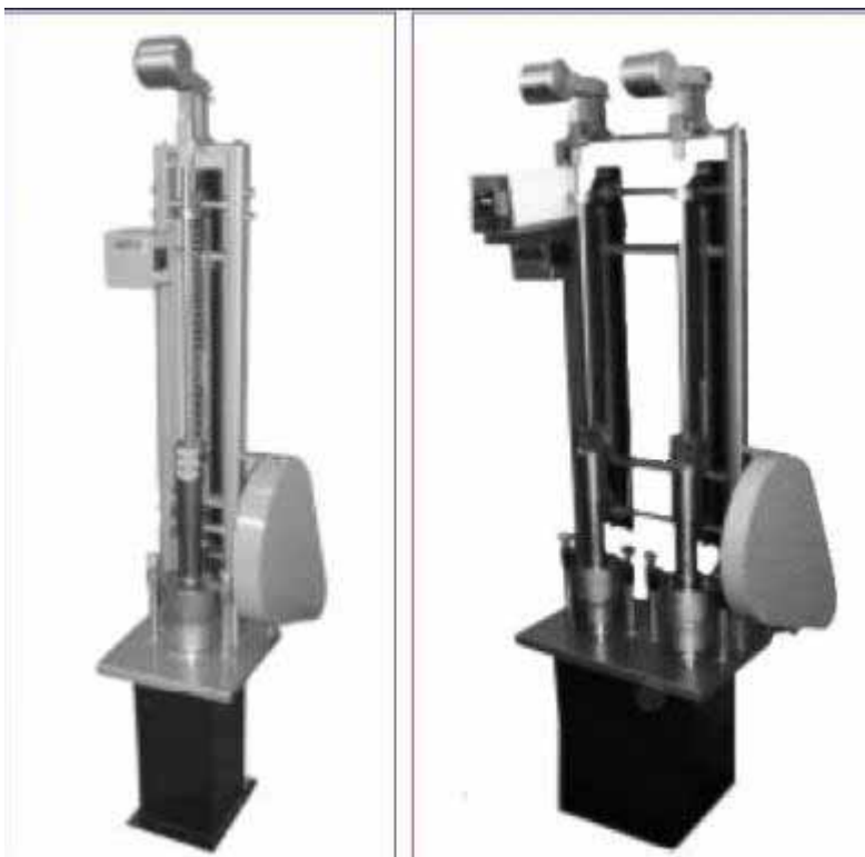
SOQUETE MARSHALL: soquete com peso de impacto de 10 lb
