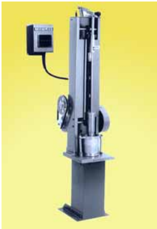
COMPACTADOR MECÂNICO ELÉTRICO PARA ENSAIO MARSHALL
