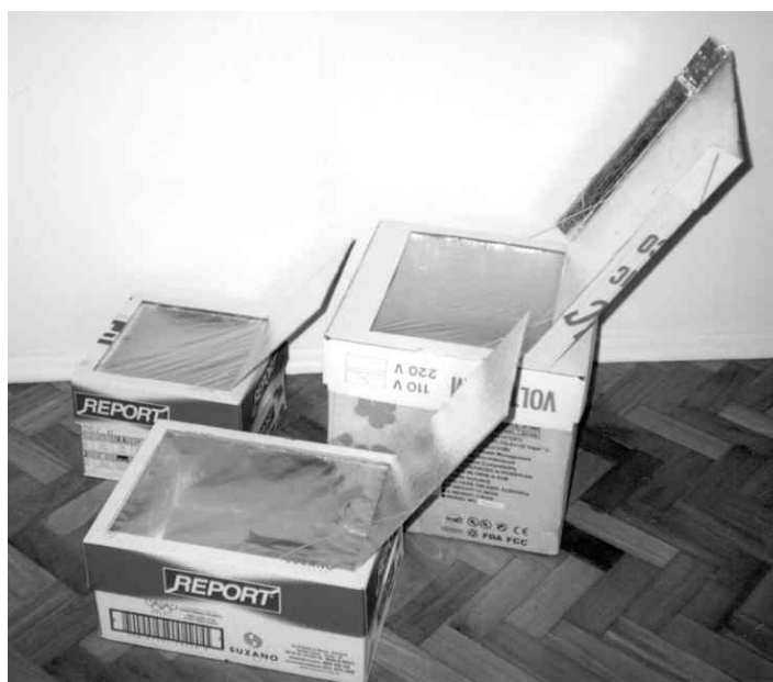
Figura G.7 - Fotografia de três dos fornos utilizados nas aulas. O menor é o forno pronto pequeno (31cmX31cm), o seguinte é o forno didático do mesmo tamanho do forno dos alunos (44cmX31cm) e o maior é o forno grande utilizado na aula de cozimento.
