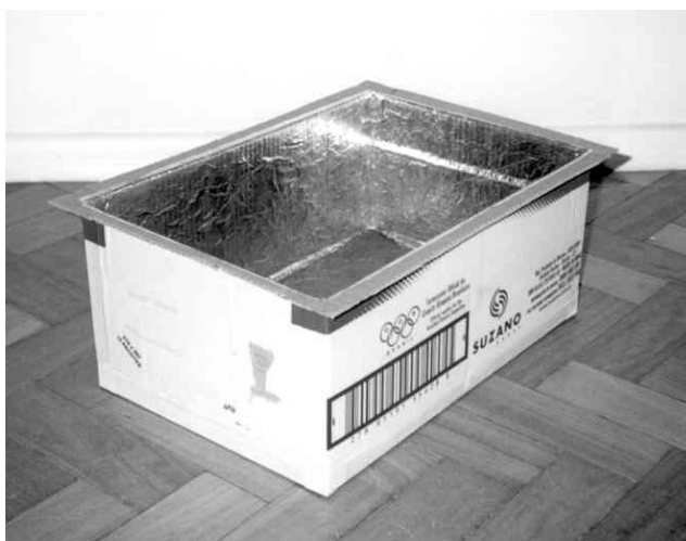
Figura G.4 - Fotografia da caixa interna do forno didático. Pode-se ver a forração de papel alumínio, o fundo preto e a borda horizontal dobrada para fora que deve ser colada na borda horizontal da caixa externa.
