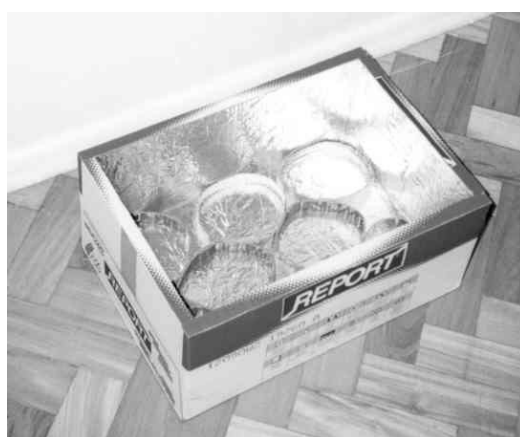
Figura G.3 - Fotografia da caixa externa do forno didático. Corresponde ao desenho na figura G.2. Pode-se ver a forração de papel alumínio, os anéis de suporte colados ao fundo e as bordas horizontais dobradas para dentro.
