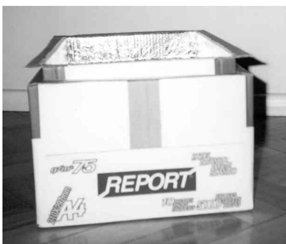
Figura G.5 - Fotografia do encaixe das duas caixas. A caixa interna está sendo colocada dentro da caixa externa. Pode-se ver a diferença entre o tamanho das duas caixas e como a borda horizontal da caixa interna irá se ajustar à borda horizontal da caixa externa.
