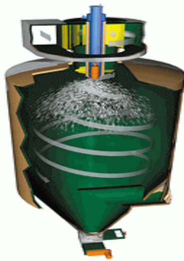
Figuras 2.2 e 2.3. Equipamentos para remoção de SO 2 e NO x . (SEGHERS, 2002). À esquerda (Fig.2.2), atomizador (tecnologia rotacional) de solução de cal para a remoção de SO 2 e resfriamento dos gases. À direita (Fig.2.3), redutor seletivo catalítico (SCR) para NO x , através de reações termoquímicas, com injeção de amônia (NH 3 ) ou uréia (CO(NH 2 ) 2 ) nos gases, em presença de um catalisador.
