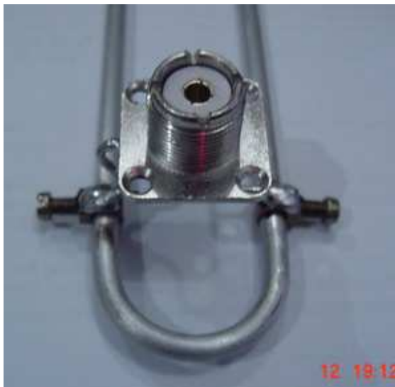
Socket SO-239 sudah di solder pada elemen antenna Super J-Pole.
