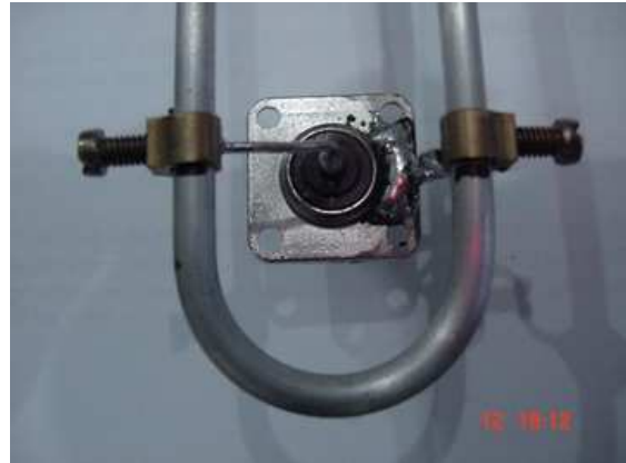
Socket SO-239 tampak bawah sebelum diberi Araldit untuk pelindung terhadap cuaca.
