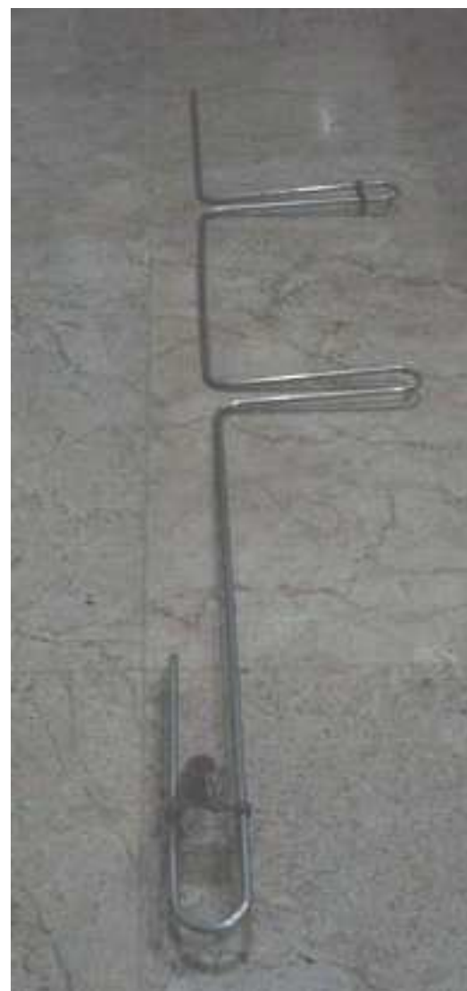
Antena Super J-Pole yang sudah selesai dibuat dan siap dituning dan digunakan.
