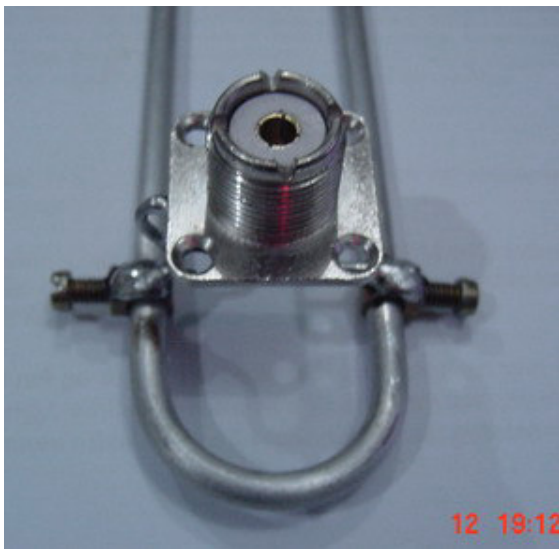
Socket SO-239 sudah di solder pada elemen antenna J-Pole.
