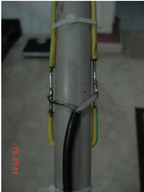
J-Pole dari kabel NYY siap digunakan
