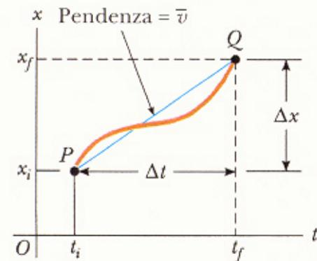
**Figura 2.1** Grafico posizione-tempo per una particella in moto lungo l'asse  $x$ . La velocità media  $\bar{v}_x$  nell'intervallo  $\Delta t = t_f - t_i$  è la pendenza della retta congiungente  $P$  e  $Q$ .
