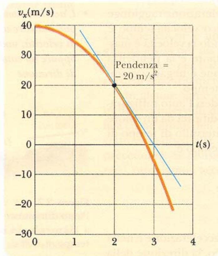
**Figura 2.8** (Esempio 2.4) Grafico velocità-tempo per una particella in moto lungo l'asse  $x$  secondo la relazione  $v_x = (40 - 5t^2)$  m/s. Si noti che l'accelerazione a  $t = 2.0$  s è uguale alla pendenza della tangente a quell'istante.
