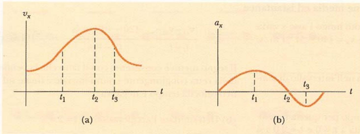
**Figura 2.6** L'accelerazione istantanea può essere ottenuta dal grafico (a) velocità-tempo. A ciascun istante, l'accelerazione nel grafico (b) di  $a_x$  in funzione di  $t$  è uguale alla pendenza della tangente alla curva  $v$  in funzione di  $t$ .
