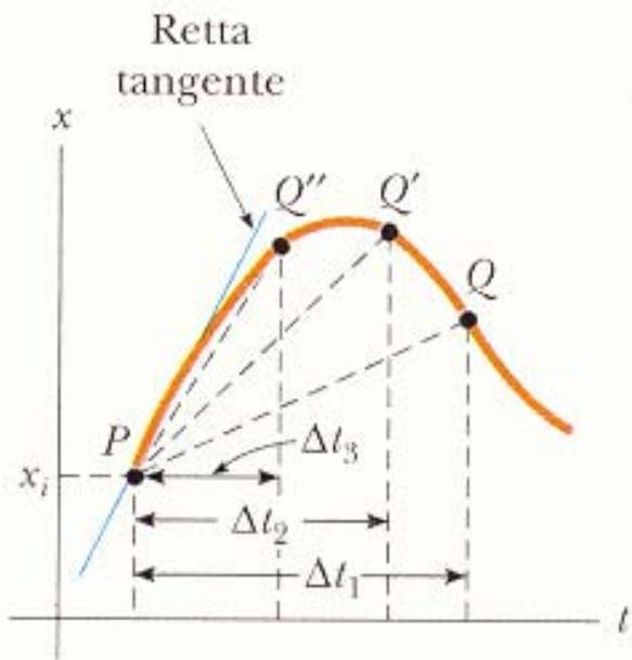
**Figura 2.2** Grafico posizione-tempo per una particella in moto lungo l'asse  $x$ . Allorquando gli intervalli di tempo considerati a partire da  $t_i$  divengono sempre più piccoli, la velocità media per quell'intervallo tende alla pendenza della retta tangente in  $P$ . La velocità istantanea in  $P$  è definita come la pendenza della tangente all'istante  $t_i$ .
