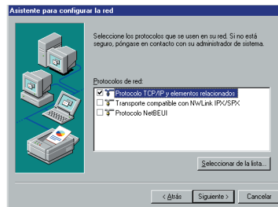
Figura 5.10 Instalación de protocolos de red
