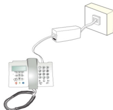
Figura 3.2 Cableado en el microfiltro
