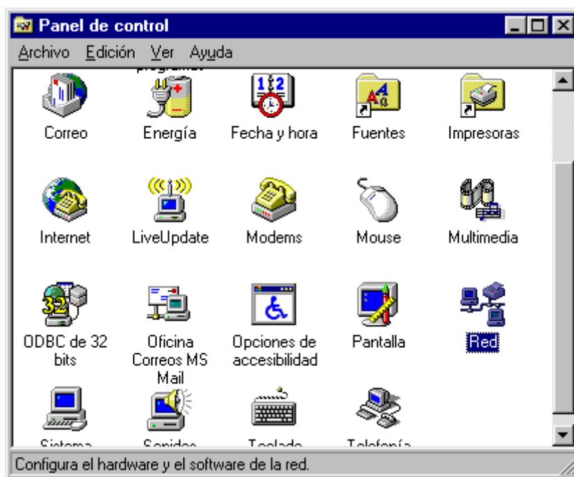
Carpeta de Acceso para la instalación del protocolo TCP/IP
