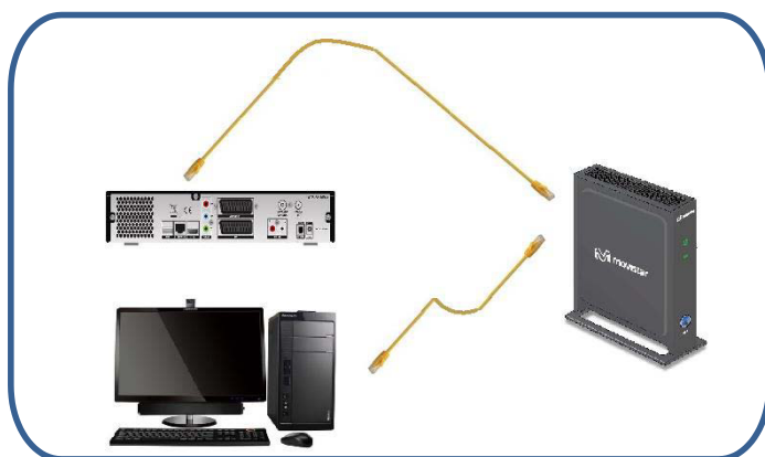
Figura 2. Conexión a Descodificador Imagenio o a PC.
