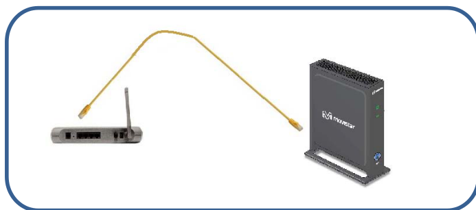
Figura 1. Conexión Adaptador a Router Imagenio
