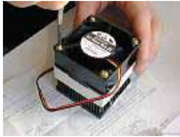
Figura (3.12).- Colocación de los tornillos al disipador
