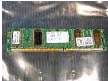
Figura (3.15).-Memoria de 128 MB DIMM de 184 pines,
