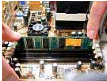
Figura (3.16).- Instalación de la memoria
