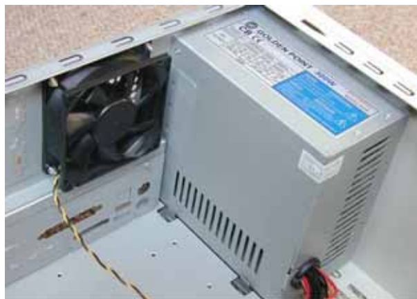
Figura (3.3).- Fuente y ventilador
